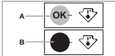
**i** Når du har sat de friske madvarer i apparatet eller efter at have åbnet døren flere gange i træk eller i en lang periode, er det normalt, at lampen ikke vises OK. Vent mindst 12 timer, inden du genjusterer temperaturvælgeren.
