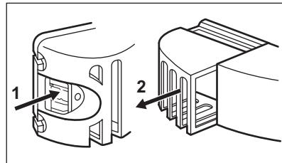
3. Skift ut lyspære med en pære med samme effekt og form, og som er spesielt beregnet på husholdningsapparater.
