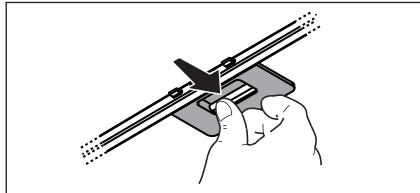
Il filtro al carbone può essere lavato ogni due mesi (o quando il sistema di indicazione di saturazione dei filtri - se previsto sul modello in possesso- indica questa necessità) in acqua calda e detergenti idonei o in lavastoviglie a 65°C (in caso di lavaggio in lavastoviglie eseguire il ciclo di lavaggio completo senza stoviglie all'interno).
