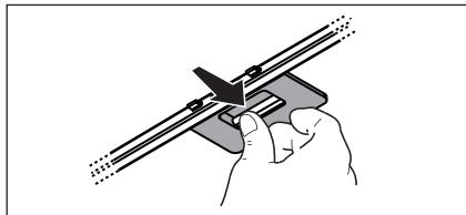
Le filtre à charbon peut être nettoyé tous les deux mois (ou lorsque le système d'indication de saturation des filtres – si prévu sur le modèle possédé – indique cette nécessité) avec de l'eau chaude et au moyen de détergents appropriés ou dans le lave-vaisselle à 65°C (dans le cas de lavage dans le lave-vaisselle suivre un cycle de lavage complet sans vaisselle à l'intérieur).
