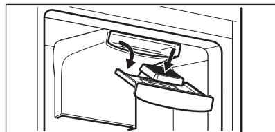
En gang om året bør det aktive kulfILTER skiftes for at sikre, at det virker optimalt.
