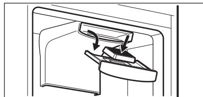
Per garantire il massimo rendimento, sostituire il filtro dell'aria al carbone una volta all'anno.
