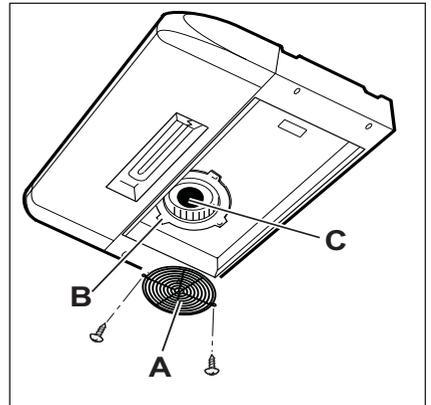
**4.1 Fettfilter** - Filtret skall rengöras en gång i månaden, med ett mildt rengöringsmedel, för hand eller i diskmaskin, med låg temperatur och kort program. Vi tvätt i diskmaskin kan fettfiltret av metall missfärgas utan att detta på något sätt påverkar filtrets uppsugningsförmåga.
