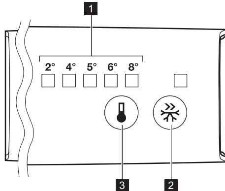
1 Lämpötilanäytö LED
