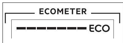
ECOMETER indikerar hur programvalet påverkar energi- och vattenförbrukning. Ju fler staplar som lyser, desto lägre förbrukning.
