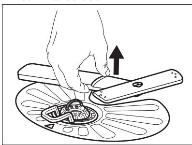
2. Skölj spolarmen under rinnande vatten. Använd ett tunt spetsigt verktyg, t.ex. en tandpetare, för att avlägsna smuts från hålen.
