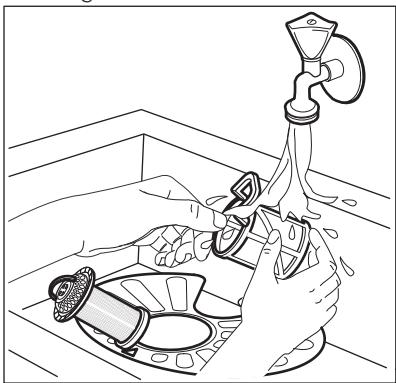
5. Kontrollera så att det inte finns några matrester eller smuts kvar i eller runt kanten på sumpen.
