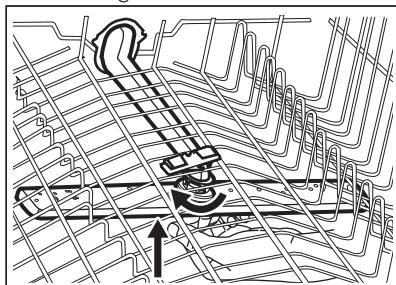
3. Skölj spolarmen under rinnande vatten. Använd ett tunt spetsigt verktyg, t.ex. en tandpetare, för att avlägsna smuts från hålen.
