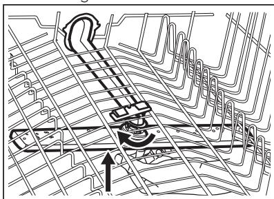
3. Skölj spolarmen under rinnande vatten. Använd ett tunt spetsigt verktyg, t.ex. en tandpetare, för att avlägsna smuts från hålen.
