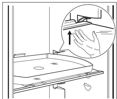
För att ändra på hyllans position kan du sätta din hand under hyllans baksida, skjuta den uppåt för att lossa klämmorna och samtidigt dra ut glashyllan ur skåpet.
