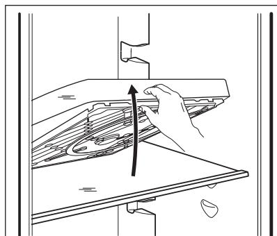
2. Dra brickan i den riktning som visas för att få klämmorna att lossa brickan.
