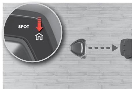
**Prenehajte s sesanjem in pošljite robota na polnilno postajo:** Pritisnite tipku »Domov«. Če se robot ni zagnal na polnilni postaji, se vrne na začetno mesto.
