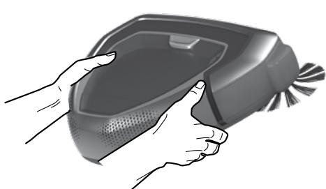
**Transportați întotdeauna robotul cu ambele mâini ținând partea frontală în sus. Mutarea manuală a robotului:** Nu se recomandă mutarea robotului în timpul aspirării deoarece ar putea reporni aspirarea de la început.
