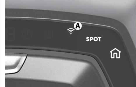
**3.** Ko je nastavitev končana, robota obrnite v običajen položaj. Zasveti simbol WiFi (A) in na ta način ponazarja povezavo robota z domaćim omrežjem.
