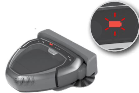
**3. Puneți robotul pe Stația de încărcare.**
