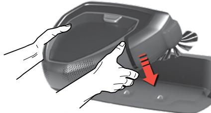
**Для того, щоб перезапустити робот-пилосос і використовувати його знову, під'єднайте його до бази заряджання.** Ви можете також вимкнути робот-пилосос на зарядній базі, тоді, щоб користуватися ним надалі, потрібно підняти пилосос з бази та повернути його назад.
