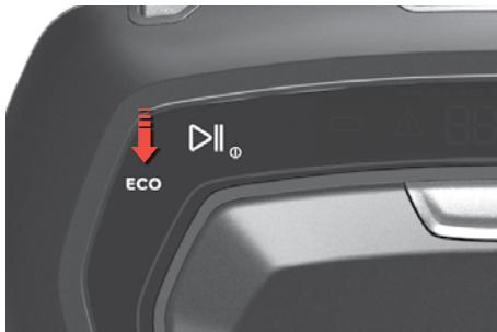
**Режим ECO:** Для полегшеного прибирання натисніть кнопку ECO, щоб зменшити потужність, збільшити час роботи та знизити рівень шуму. Робот-пилосос залишатиметься у режимі ECO, поки кнопка не натискається знову.
