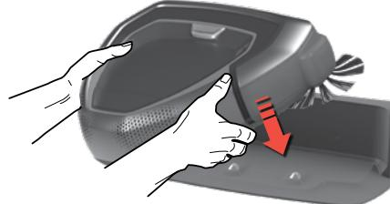
**Za ponovni zagon robota in njegovo ponovno uporabo ga namestite na polnilno bazo.** Robota lahko izklopite tudi na polnilni bazi. Če ga želite uporabljati, ga morate dvigniti in znova namestiti na polnilno bazo.
