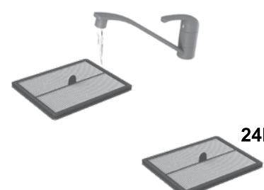
**3. Filter izperite s hladno vodo.** Potresite okvir filtra, da odstranite vodo. Preden ga namestite nazaj v sesalník, naj se suší 24 ur.
