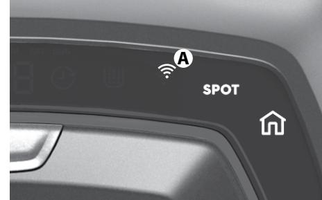
**3. După încheierea configurării, întoarceți robotul înapoi în poziția sa normală. Simbolul WiFi (A) va fi aprins pentru a indica faptul că robotul este conectat la rețea dvs. din locuință.**
