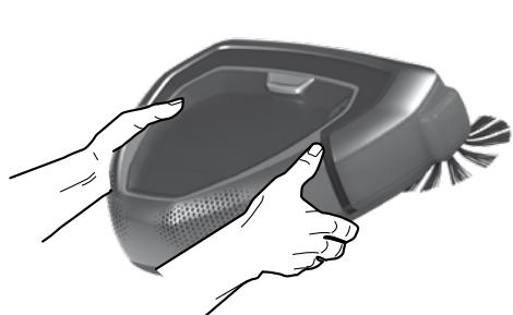
**Робота увек носите са две руке, држећи га напред и горе. Ручно померање робота:**
