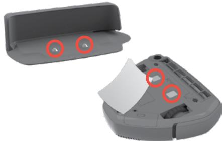
**Folosiți o lavetă moale și uscată pentru a curăța regulat conectorii de încărcare de pe stația de încărcare și de sub aparat.**
