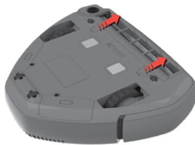
1. Притисните два држача и повучите поклопац унапред да бисте уклонили поклопац котрљајуће четке.
