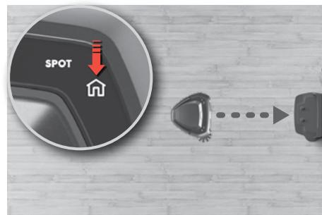
**Oriți aspirarea și trimiteți robotul la stația de încărcare:** Apăsați butonul Acasă. Dacă robotul nu este pornit de la stația de încărcare, acesta va reveni la poziția de start.
