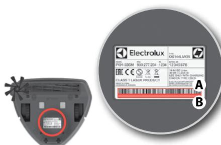
**2. În timpul procesului, aplicația vă va cere să întoarceți robotul cu față în jos pentru a activa modulul WiFi și pentru a scană codul de bare cu numărul de serie (A) sau pentru a-l introduce manual (B). După care continuați să urmați instrucțiunile din aplicație.**
