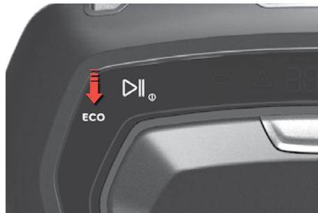
**Modul Eco:** Pentru o aspirare mai ușoară, apăsați butonul ECO pentru a reduce puterea, prelungind durata de funcționare și reducând nivelul zgomotului. Robotul va rămâne în modul ECO până când butonul este apăsat din nou.
