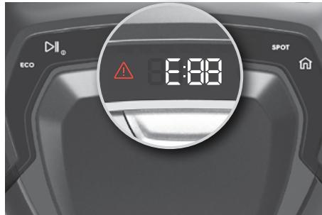
**1. Dacă apare o eroare, robotul se oprește din aspirare.** Pictograma de avertizare va pulsa și este afișat „E:” urmată de un cod de eroare. Difuzorul va descrie, de asemenea, eroarea. După apariția unei erori, apăsați orice buton pentru a reda din nou mesajul audio.
