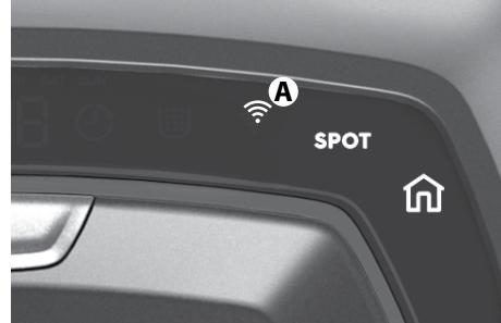
**3. Після завершення установки поверніть робот-пилосос у звичайне положення. Символ WiFi (A) буде світитися, вказуючи, що робот-пилосос підключений до домашньої мережі. **Примітка:** Потрібно декілька хвилин, щоб годинник робота-пилососа автоматично синхронізувався з вашим мобільним пристроям.**
