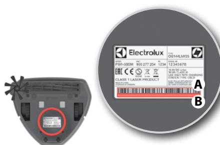
**2. Under processen kommer Appen att be dig att använda roboten för att aktivera WiFi-modulen och skanna serienummer streckkod (A) eller ange den manuellt (B).**
