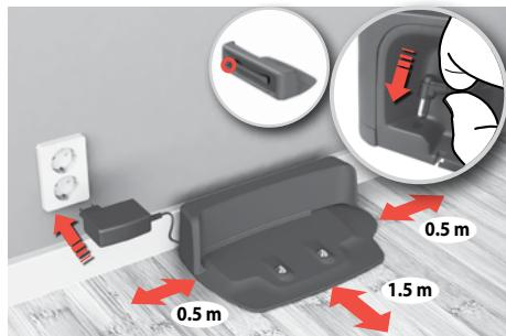
**1. Placera laddaren på golvet** mot väggen. Anslut adaptern till strömuttaget på nedre sidan. Anslut nätsladdens kontakt till vägguttaget. Linda upp överflödig sladd på baksidan. Kontrollera att det finns ett tomt område runt 0,5 m på sidorna och 1,5 m framför laddningsstationen. **WiFi modell:** Placera basen inom området för WiFi router.
