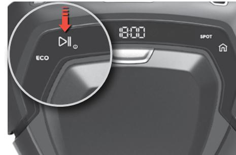
**2. Když je chyba vyřešena,** stisknutím tlačítka spuštění/pozastavení spustíte vysávání.
