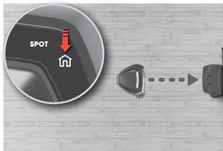
**Stopp rengjøring og send robotten til ladestasjonen:** Trykk på Hjem-knappen. Hvis robotten ikke er startet fra laderen, går den tilbake til utgangsposisjonen.
