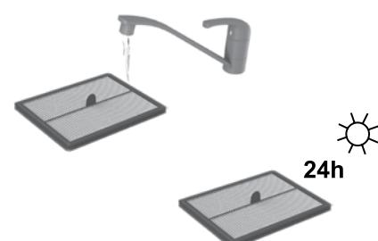
**3. Skölj filtret med kallt vatten.** Knacka på filterramen för att avlägsna vatten. Låt det torka i 24 timmar innan du lägger tillbaka den i maskinen.
