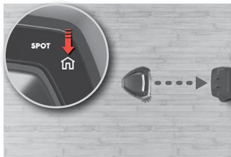
**Stop støvsugningen, og send robotten til ladestationen:** Tryk på Home-knappen. Hvis robotten ikke startes fra ladestationen, vender den tilbage til startpositionen.
