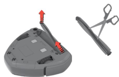
**2. Trekk ut børstevalsen og rengjør børstene og lagrene.** Fjern tråder ved å klipe dem bort med saks. Monter i motsatt rekkefølge.
