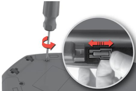
**1. Batteriommet er plassert på undersiden av roboten.** Bruk en skrutrekker (PH2) for å skru løs batterilokket. Bytt ut batteriene og sett på batterilokket.
