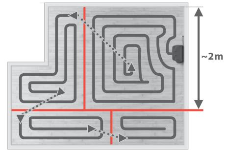
**2. Čišćenje velikih prostorija bit će podijeljeno na dijelove od 2x2 m.**
