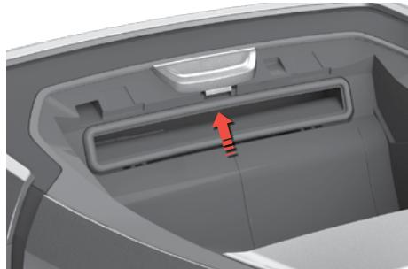
**Vyjměte nádobu na prach.** Odstraňte nečistoty zachycené ve vzduchovodu. Vratte nádobu na prach zpět na místo.
