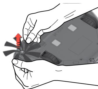
**Vyjměte boční kartáč vytažením.** Boční kartáč vyčistěte. Připojte boční kartáč zpět do držáku. Boční kartáč lze vyměnit. (Ref: ERK2 / EBSB2)
