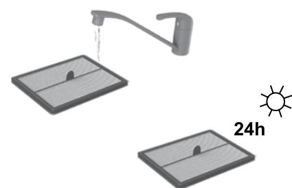
**3. Skyll filteret med kaldt vann.** Trykk på filterrammen for å fjerne vann. La tørke i 24 timer før du legger det tilbake i maskinen.
