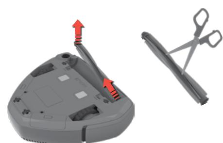
**2. Izvucite četkasti valjak i očistite četku i ležajeve. Izvadite zapetljane vlasti pomoću škara. Ponovo stavite natrag na mjesto. Četkasti valjak možete mijenjati. (Ref: ERK2)**
