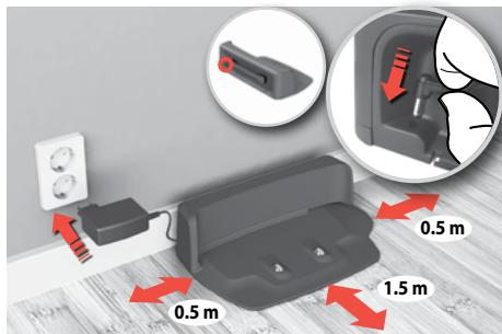
**1. Plasser ladeasjenen** på gulvet mot veggen. Plugg adapteren til strømkontakten på siden av stasjonen. Sett stopselet i stikkontakten. Trekk opp ledningen på baksiden av stasjonen. Sørg for at det er et tomt område på 0,5 m på sidene og 1,5 m foran laderen.
