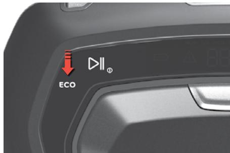
**Način rada ECO:** Kod manje količine čišćenja pritisnite gumb ECO kako bi se smanjilo napajanje, produžilo vrijeme rada i smanjila razina buke. Robot će ostati u načinu rada ECO sve dok ponovno ne pritisnete gumb.
