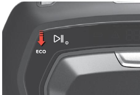
**ECO-modus:** For en lettere rengjøring, trykk på ECO-knappen for å redusere strøm, forlenge driftstiden og redusere støy niveauet. Robotten vil bli i ECO-modus fram til du trykker på knappen igjen.
