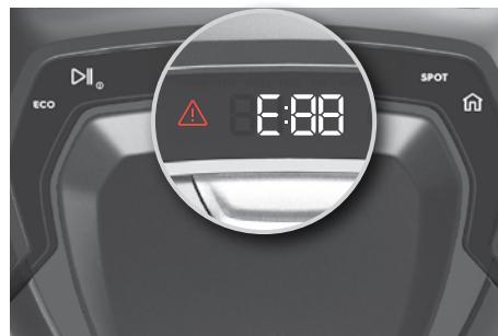
**1. Ako se pojavi greška,** robot prekida čišćenje. Ikona upozorenja treperi i prikaže se slovo "E": **nakon čega se na zaslonu prikaže kod greške.** Greška će se opisati putem zvučnika. Nakon pojave greške pritisnite bilo koji gumb kako biste ponovno reproducirali zvučnu poruku.
