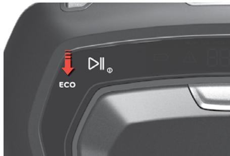
**ECO-läge:** För lättare städning, tryck på ECO-knappen för att minska effekten, förlänga användningstiden och minska bullernivån. Roboten kommer att stanna i ECO-läge tills knappen trycks in igen.
