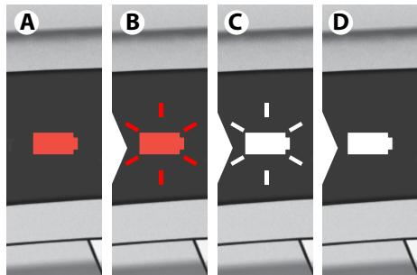
**1. Crvena baterija (A)** označava da je robot potreban napuniti. **Crveno trepereće svjetlo (B):** Robot se puni - niska razina napunjenošću baterije. **Bijelo trepereće svjetlo (C):** Baterija robota je dovoljno puna za korištenje. (Pritisnite gumb Reproduciraj/Pauziraj za čišćenje.) **Bijelo svjetlo (D):** Robot je spreman za korištenje. Približno 3 sata potrebna su da se baterija robota napuni do kraja.
