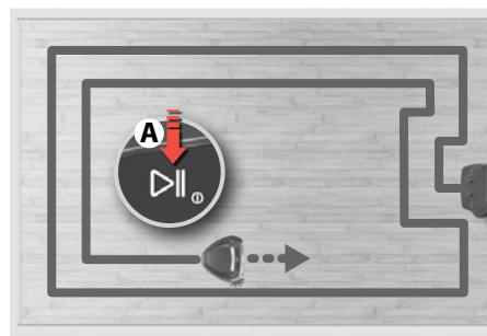
**1. Za pokretanje čišćenja pritisnite gumb Reproduciraj/Pauziraj (A). Nekoliko sekundi nakon pokretanja započinje čišćenje. Robot počinje čistiti uz zidove pa onda prema središnjem dijelu.**
