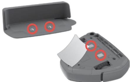
**Använd en torr, mjuk trasa för att regelbundet rengöra laddningsanslutningarna** på laddningsbasen och under maskinen.
