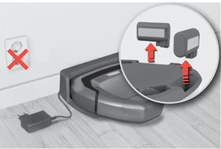
**3. Förvaring (ej inkopplad):** Om robotten lagras en längre tid utan att laddas, ta ur batterierna och förvara dem separat. (Ladda batterierna innan du tar dem).
