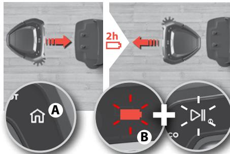
**Om laddning skulle behövas under rengöring,** tänds hemknappen och roboten återgår till laddaren. Hemknappen (A) lyser Batteriet och Play/Pause (B) blinkar för att indikera att roboten laddas och att den kommer att fortsätta där den stoppades. Roboten kommer att laddas upp till 80 % för att snabbare återuppta rengöring. Laddningstiden är ~ 2 timmar.
