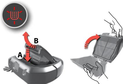
**1. Leeren Sie den Staubbehälter** regelmäßig oder wenn das Staubbehälter-Symbol leuchtet.
