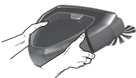
**Bær altid robotten med begge hænder og med forsiden opad. Manuel flytning af robotten:**
