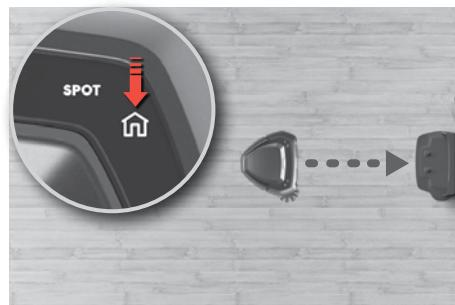
**Zastavte vysávání a pošlete robotický vysavač do dobíjecí stanice:** Stiskněte tlačítko návratu domů. Pokud robotický vysavač nebyl spuštěn z dobíjecí stanice, vrátí se do zahajovací pozice.
