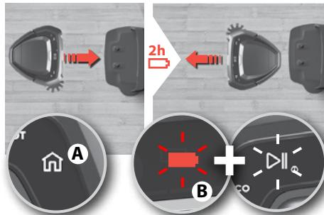
**Hvis lading trengs under rengjøring,** vil hjem-knappen lyse og robotten vil gå tilbake til ladestasjonen. Hjem-knappen (A) lyser Batteriet og Start/Pause-knappen (B) blinker for å indikere at robotten lader og at den vil fortsette der den stoppet.
