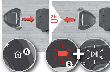
**Hvis det bliver nødvendigt med opladning under støvsugningen**, tændes Home-knappen, og robotten vender tilbage til ladestationen. Home-knappen (A) lyser. Batteri- og Play/pause-knappen (B) blinker for at angive, at robotten oplades, og at den vil fortsætte, hvor den stoppede. Robotten oplades op til 80 % for at genoptage støvsugningen hurtigere. Opladningstiden er ~2 timer.
