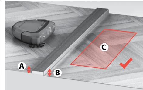
**Před přejetím prahu nebo překonáním překážky** se robotický vysavač zastaví a zkонтroluje:
