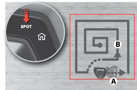
**SPOT-støvsugning (lille område ~1 m<sup>2</sup>):** Anbring robotten med front mod pletten, og tryk på SPOT-knappen. Robotten støvsuger området to gange.
