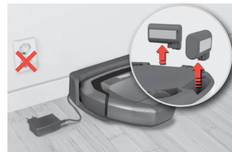
**1. Rødt batteri (A)** indikerer at roboten trenger å lades.
