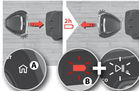
**Pokud bude během vysávání nutné robotický vysavač dobrít**, rozsvítí se tlačítko návratu domů a vysavač se vrátí do dobíjecí stanice. Tlačítko návratu domů (A) svítí. Baterie a tlačítko spuštění/pozastavení (B) blikáním signalizují, že robotický vysavač se dobijí a že bude ve vysávání pokračovat tam, kde přestal. Robotický vysavač se dobije na 80 %, aby mohl pokračovat ve vysávání rychleji. Dobítí trvá přibližně dvě hodiny.
