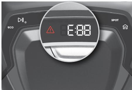
**1. Robotten stopper støvsugningen**, hvis der opstår en fejl. Advarselslampa blinker, og bogstavet «E:» **efterfulgt af en fejlkode** vises i displayet. Højttaleren vil også beskrive fejlen. Tryk på en vilkårlig knap for at afspille lydmeddelelsen igen, når der er opstået en fejl.
