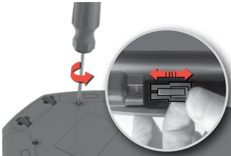
**1. Batterirummene er placeret på undersiden af robotten.** Brug en skruetrækker (PH2) til at løsne lågene til batterirummene. Udskift batteripakkerne, og sæt lågene til batterirummene på plads.
