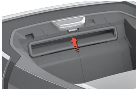
**Izvadite spremnik za prašinu.** Uklonite ostatke zaglavljene u zračnom kanalu. Stavite spremnik za prašinu natrag na mjesto.
