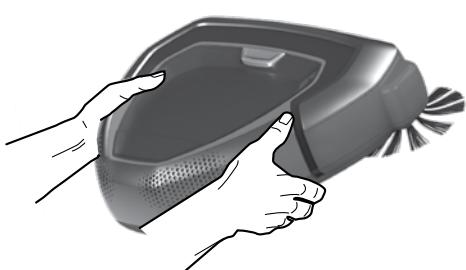
**Iltid roboten med to hender og fronten opp.** **Manuell flytting av roboten:** Flytte roboten under rengjøringen anbefales ikke, da det kan starte rengjøring fra begynnelsen.
