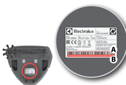
**2. V průběhu akce vás aplikace vyzve, abyste otočili robotický vysavač vzhůru nohama, zapnuli modul WiFi a naskenovali čárový kód sériového čísla (A) nebo ho zadali ručně (B). Pokračujte podle pokynů aplikace.**
