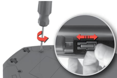
**1. Prostor pro baterie se nachází na spodní straně robotického vysavače.** Pomocí šroubováku (PH2) odšroubujte víka prostoru pro baterie. Vyměňte oba bateriové moduly a vratte zpět víka prostoru pro baterie.
