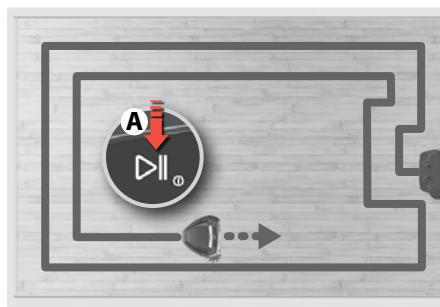
**1. Stisknutím tlačítka spuštění/pozastavení (A) spustíte vysávání. Několik sekund po spuštění se zahájí vysávání. Robotický vysavač začne vysávat podél zdí a bude postupovat směrem dovnitř.**
