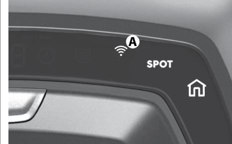
**3. När installationen är klar, vrid roboten tillbaka till sitt normala läge. WiFi symbolen (A) tänds för att indikera att roboten är ansluten till hemnätverket. Notera: Det kan ta en stund innan roboten automatiskt synkroniseras med din mobila enhet.**
