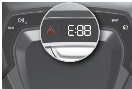
**1. Hvis det oppstår en feil**, stopper roboten rengjøringen. Varselikonet pulserer og sifferet "E:" etterfulgt av en feilkode, vises på displayet. Høyttaleren vil også beskrive feilen. Etter en feil har oppstått, trykker på hvilken som helst knapp for å spille av lydmeldingen igjen.
