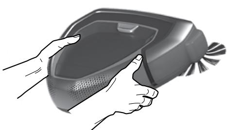
**Vždy přenášejte robotický vysavač oběma rukama přední částí nahoru. Ruční posouvání robotickým vysavačem:** Nedoporučuje se posouvat robotický vysavač během vysávání, protože mohlo spustit vysávání od začátku.
