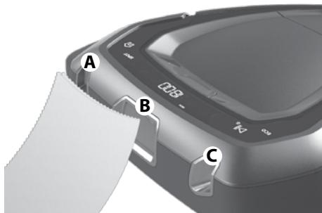
**Systém 3D Vision funguje nejlépe tehdy, když jsou okna (A, B, C) čistá a nepoškrábaná.**
