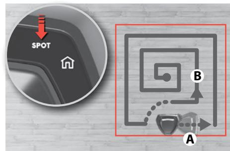
**Čišćenje SPOT (malo područje, približno 1 m<sup>2</sup>):** Postavite robot nasuprot malog području i pritisnite gumb SPOT. Robot će to područje počistiti dva puta.
