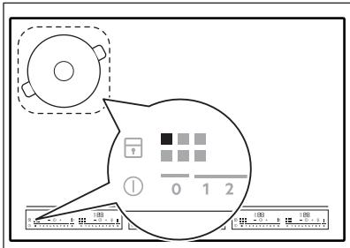
Varje fyrkant på kontrollpanelen representerar en kokzon på induktionskokningsytan.
