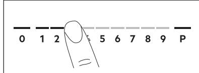
Kun alueelle on asetettu keittoastia ja tehotaso on asetettu, se jää päälle 2 minuutin ajaksi keittoastian poistamisen jälkeen. Säätöpalkki ja keittoalueen merkkivalo vilkkuvat 2 minuutin ajan. Jos keittoastia asetetaan uudelleen keittoalueelle tämän ajan kuluessa, tehotaso aktivoituu uudelleen. Muutoin keittoalue kytkeytyy pois toiminnasta.
