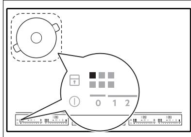
Käyttöpaneelin neliot vastaavat induktiokeittotason keittoalueita. Alueiden merkkivalot ilmoittavat keittoalueen, johon säätöpalkki viittaa.
