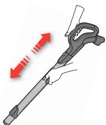
5. Регулирайте телескопичната тръба като с едната си ръка дръжките натиснат застопоряващия бутон и изтегляте дръжката с другата си ръка.
