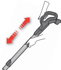
4. **Raccordez le tube télescopique à la poignée du flexible** (pour le désassembler, appuyez sur le bouton de verrouillage et tirez sur la poignée du flexible).
