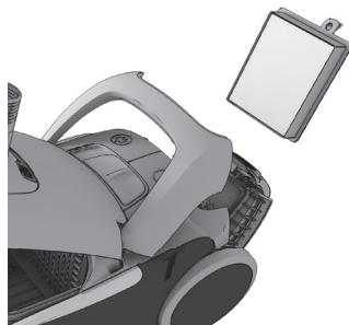
1. **Modeliai su skaitmeniniu ekranu:** Pakeiskite / išvalykite\* išmetimo filtru, kai užsižiebs indikatorius „filteras“. \*Tik plaunamieji filtrais
