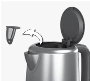
2. **Aby wyczyścić filtr siatkowy, należy go wyjąć z obudowy zasilnika, naciskając go delikatnie najpierw z jednej, a potem z drugiej strony.** Aby z powrotem włożyć filtr, należy najpierw umieścić jego dolną część w otworze, a następnie, delikatnie naciskając, wsunąć górną część w odpowiednie otwory. **Czyszczenie płytki podstawy** – do czyszczenia metalowej płytki podstawy można użyć specjalnego środka do czyszczenia stali nierdzewnej.
