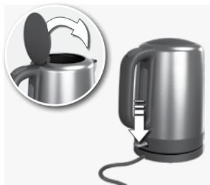
**4. Zatvorte kryt** a uistite sa, že zapadol správne. V opačnom prípade nebude funkcia automatického vypínania fungovať spoľahlivo. **Položte kanvicu na základňu.** Stlačte VYPÍNAČ nadol. Svetelný indikátor sa rozsvieti a kanvica začne zohrievať vodu.
