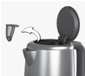
2. Filtri puhastamiseks vajutage õrnalt selle ühele ja seejärel teisele küljele, et vabastada see veekeetja korpuse küljest. Filtri paigaldamiseks tagasi asetage esmalt alumine osa süvendisse ning seejärel vajutage ülemine osa õrnalt ettenähtud pesadesse.
