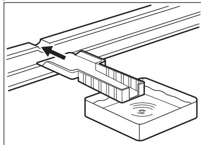
Voit nopeuttaa sulatusta laittamalla lämmintä vettä sisältävän astian pakastimen sisään. Poista myös sulatuksen aikana irtoilevat jäälpat pakastimen sisältä.
