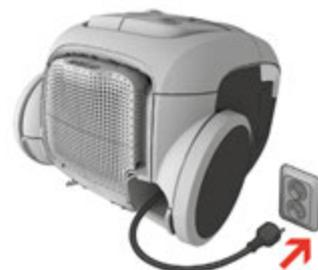
6. **Ištraukite maitinimo laidą ir įjunkite jį į elektros tinklą.**
