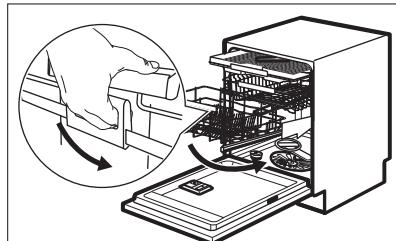
Når utløserens håndtak løftes opp, trykker du stativet ned. Mekanismen går tilbake til det nedre nivået, som er grunnleggende posisjon. Det finnes to måter å senke mekanismen på, avhengig av hvordan kurven er fylt opp:
