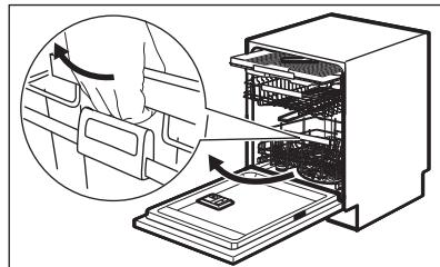
Kurven lukkes automatisk på det øvre nivået. Vær forsiktig når du setter inn eller tar ut av kurven (se brosjyren om kurvene).
