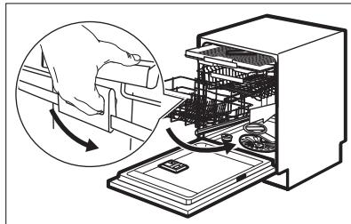
Kun kytkinkahva on nostettu ylös, paina teline alas. Mekanismi palaa perusasentoon alatasolle.
