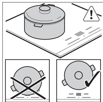
Plasser kokekaret på korset/firkanten som er på kokeoverflaten. Dekk krysset/firkanten helt. Induksjonskokesonen tilpasser seg størrelsen på kokekarets bunn automatisk. Du kan bruke store kokekar på to kokesoner samtidig.
