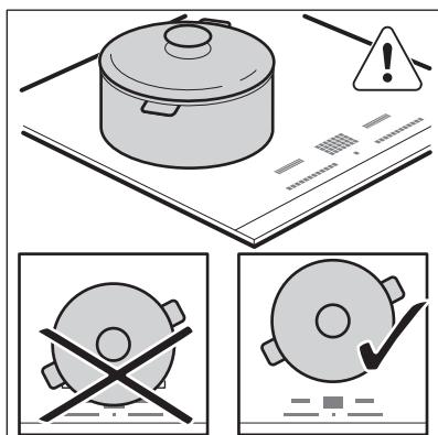
Ställ kokkärllet på korset / fyrkanten som är markerad på kokytan. Täck korset/ fyrkanten helt. Induktionskokzonerna anpassar sig automatiskt till storleken på kokkärllets botten. Du kan använda ett stort kokkärl på två kokzoner samtidigt.
