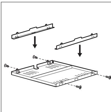
Jos käytössä on suojakotelo (lisävaruste), edessä oleva 2 mm:n ilmavirtaustila ja keittotason alapuolella oleva suojaataso eivät ole tarpeen. Suojakotelo ei välttämättä ole saatavilla kaikissa maissa lisävarusteena. Ota yhteys paikalliseen jälleenmyyjään.
