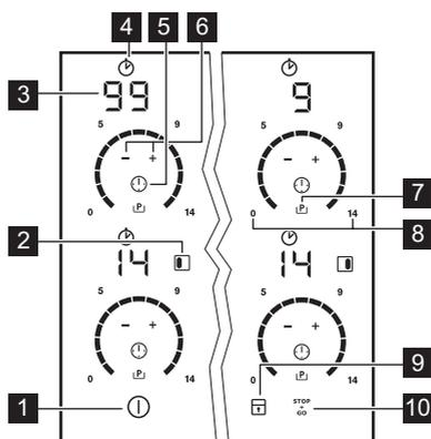
For å se betjeningspanelet, aktiver produktet med ①.
