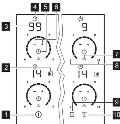
K zobrazení ovládacího panelu zapněte spotřebič pomocí ①.
