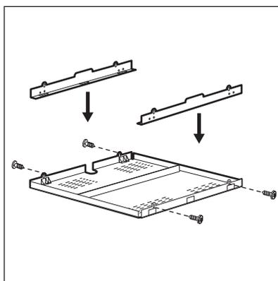
Hvis du benytter en beskyttelsesboks (tilleggsutstyr), er det ikke behov for den fremre luftspalten på 2 mm og beskyttelsesbunnen rett under koketoppen. Beskyttelsessettet er kanskje ikke tilgjengelig i enkelte land. Ta kontakt med din lokale leverandør.
