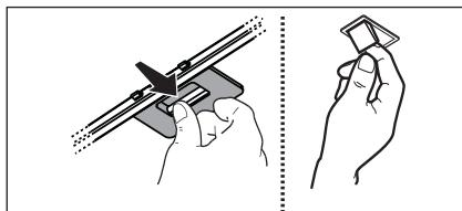
**4.2 Filter med aktivt kul der IKKE kan vaskes - KulfILTERET** skal udskiftes hver 4. Måned, hvis emhætten ikke benyttes intensivt, eller oftere. KulfILTERET kan IKKE vaskes eller genanvendes.
