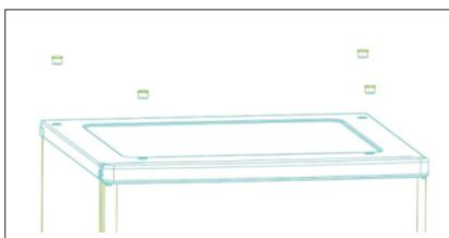
1. Reis opp kjøleskapet, og bruk en flat skrutrekker til å ta av de fire skrudekslene bak på kjøleskapslokket.
