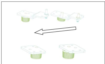
7. Skruva ur och ta bort stiftet på det nedre gångjärnet, vänd fästet och sätt dit stiftet igen. Sätt tillbaka gångjärnsfästet och passa in stiftet. Sätt tillbaka de båda justerbara fötterna. Sätt tillbaka den nedre dörren på plats. Justera dörrnivån, passa in stiftet på det nedre gångjärnet i dörrens nedre hål och dra sedan åt skruvorna.
