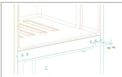
4. Ta bort de två flänsskruvarna och ta sedan bort det mittersta gångjärnet som håller den nedre dörren på plats. Lyft av den nedre dörren och lägg på en mjuk yta, så att den inte repas.
