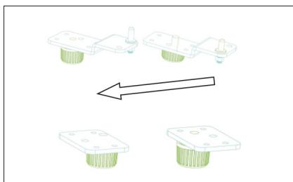
7. Skru bundhængslets stift af, vend beslaget, og sæt stiften i igen. Sæt beslaget på plads ved at montere bundhængslets stift. Skru de to justeringsfødder på igen. Sæt den nederste dør i den rigtige position. Sørg for, at døren er i vater. Sæt bundhængslets stift i dørens nederste hul, og spænd derefter boltene.
