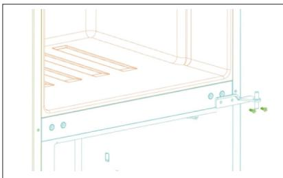
4. Ta av de to flensskruene, og ta deretter av den midterste hengselen som holder den nederste døren på plass. Løft av den nederste døren, og plasser den på et mykt underlag for å unngå skammer.
