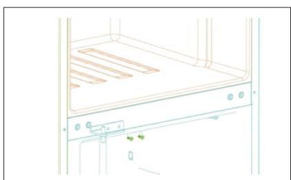
8. Vänd det mittersta gångjärnet 180 grader och flytta det sedan till den vänstra sidan. Passa in stiftet på det mittersta gångjärnet i det övre hålet på den nedre dörren, dra sedan åt skruvorna. Sätt tillbaka den övre dörren på plats. Justera dörrnivån, passa in stiftet på det mittersta gångjärnet i det nedre hålet på den övre dörren.
