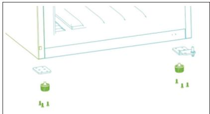
6. Ta bort de båda justerbara fötterna och ta bort det nedre gångjärnsfästet genom att skruva bort skruvarna.
