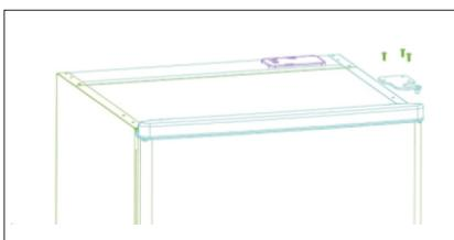
3. Irrota yläsaranan sisin osa, siirrä se vasemmalle puolelle ja kiinnitä se tukevasti.
