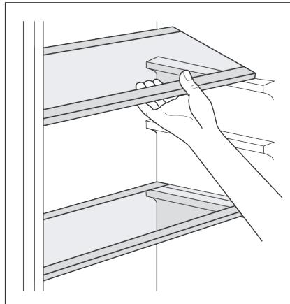
Stene hladilnika so opremljene s številnimi vodili, da so lahko police postavljene tako, kot želite.
