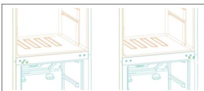
5. Irrota sarana-aukkojen suojukset laitteen oikealta puolelta ja siirrä ne avointiin aukkoihin vasemmalle puolelle.
