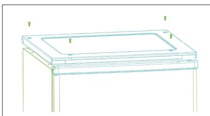
2. Skruva bort skruvarna och lyft upp panelen från baksidan och ta bort den. Lyft sedan av den övre dörren och lägg den på en vadderad yta så att den inte repas.
