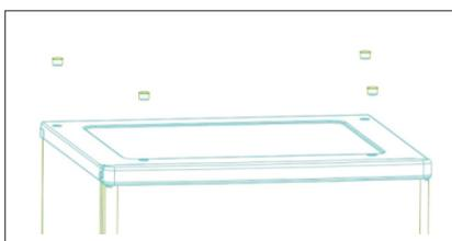
1. Nosta jäääkaappi pystyyn ja irrota 4 ruuvisuojusta sen kannen takaosasta tasapäisellä ruuvitallalla.
