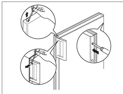
Tag bort pluggarna, skruva bort handtaget och montera det på motsatta sidan med skruvarna. Täck de öppna hålen med pluggen som ligger i förpackningen med bruksanvisningen.
