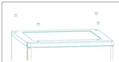
1. Uspravite hladnjak pa koristeći odvijač s ravnim vrhom odvijte 4 poklopca vijaka na poleđini poklopca hladnjaka.
