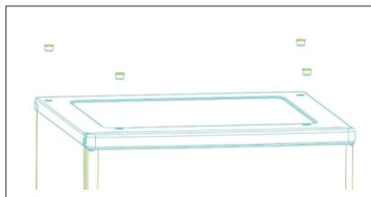
1. Rejs køleskabet op. Brug en flad skruetrækker til at fjerne de 4 skruedæksler bag på køleskabets låg.
