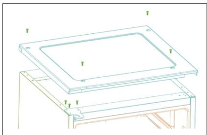
9. Sätt tillbaka panelen genom att sätta i det övre gångjärnet i hålet i den övre dörren, fäst med de 4 skruvorna. Sätt tillbaka skruvskydden.
