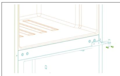
4. Fjern de to flangeskruer, og fjern derefter det midterste hængsel, der holder den nederste dør på plads. Løft den nederste dør, og anbring den på et blødt underlag for ikke at ridse den.
