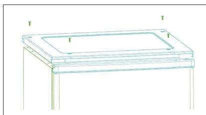
2. Løsn og løft låget bagpå, og fjern det. Løft derefter den øverste dør, og anbring den på et blødt underlag for at forhindre, at den bliver ridset.
