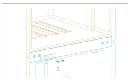
9. Udskift låget ved at montere det øverste hængsels kerne i hullet i den øverste dør, og fastgør den med de 4 skruer. Sæt de to skruedæksler på igen.
