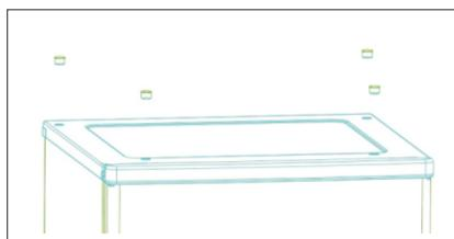
1. Hladilnik postavite pokonci in s ploščatim izvijačem odstranite 4 pokrovčke vijakov s pokrova na hrbtni strani hladilnika.
