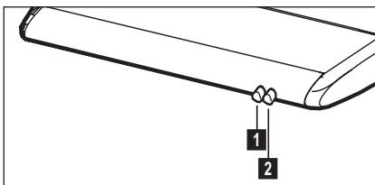
1. Lysknapp: terner og slukker ventilatorens lampe.
