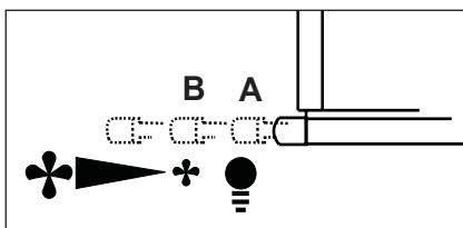
Usare la velocità maggiore in caso di particolare concentrazione di vapori di cucina. Consigliamo di accendere l'aspirazione 5 minuti prima di iniziare a cucinare e di lasciarla in funzione a cottura terminata per altri 15 minuti circa.
