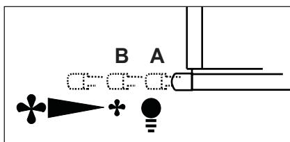
V prípade mimoriadného zhromaždenia sa pary v kuchyni, používať väčšiu rýchlosť. Odporúčame zapnúť odsávanie 5 minút pred začatím varenia a nechať ho v chode ešte približne ďalších 15 minút po ukončení varenia.
