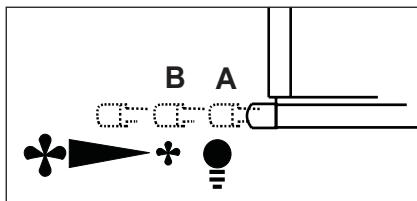
W przypadku, gdy powietrze w pomieszczeniu kuchennym jest szczególnie zanieczyszczone, należy używać okapu ustawionego na najwyższą prędkość. Zaleca się uruchomienie okapu 5 minut przed przystąpieniem do gotowania jakichkolwiek potraw i pozostawienie go włączonym jeszcze przez ok. 15 minut po zakończeniu gotowania.
