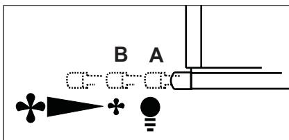
Використовуйте інтенсивну швидкість у випадку особливо високої концентрації кухонних парів. Рекомендуємо включити витяжку за 5 хвилин до початку готовування їжі і залишити його включеним на протязі 15 хвилин після закінчення готовування їжі.
