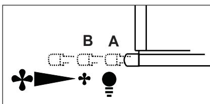
V případě velmi intenzivní koncentrace kuchyňských par použijte maximální sací výkon. Doporučuje se zapnout digestoř 5 minut před zahájením vaření a vypnout ji cca 15 minut po ukončení vaření.
