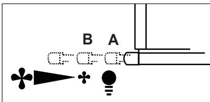
Bei starker Dampfentwicklung die höchste Betriebsstufe einschalten. Es wird empfohlen, die Dunstabzugshaube schon fünf Minuten vor Beginn des Kochvorganges einzuschalten und sie nach dessen Beendigung noch ungefähr 15 Minuten weiterlaufen zu lassen.
