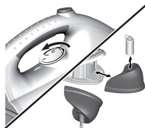
**6. Otočte volič teploty** zpátky na minimální nastavení. Poté žehličku s parním generátorem vypněte a vypojte ji ze sítě. **Vyprázdněte zásobník na vodu** a před uložením nechte žehličku zcela vychladnout.
