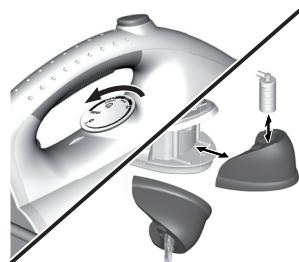
6. Impostare nuovamente il selettori della temperatura sull'impostazione minima. Spegnere, quindi, il ferro da stirio con generatore di vapore e scollararlo dalla presa di corrente. Svuotare il serbatoio dell'acqua e consentire al ferro di raffreddarsi completamente prima di riporlo.
