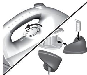
6. Rotiți selectorul de temperatură înapoi la setarea minimă. Apoi, opriți fierul de călcat cu instalatie de producere a aburului și deconectați-l de la rețeaua electrică de alimentare. Golii rezervorul de apă și lăsați fierul de călcat să se răcească complet înainte de depozitare.
