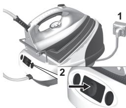
**I** 1. Collegare il ferro da stiro con generatore di vapore alla presa di corrente. Premere l'interruttore di accensione.
