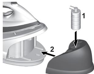
**6. Introduceți rezervorul de apă în unitatea de bază.** Asigurați-vă că rezervorul de apă este fixat bine în poziție.
