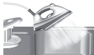
**3. Când se aprinde indicatorul luminos pentru abur, fierul de călcat este pregătit pentru auto-curățare. Țineți fierul de călcat deasupra chiuvetei în poziția de călcat. Apăsați butonul pentru abur aproximativ trei minute. Scamele și materialele libere vor fi apoi evacuate din orificiile pentru abur de sub talpă.**
